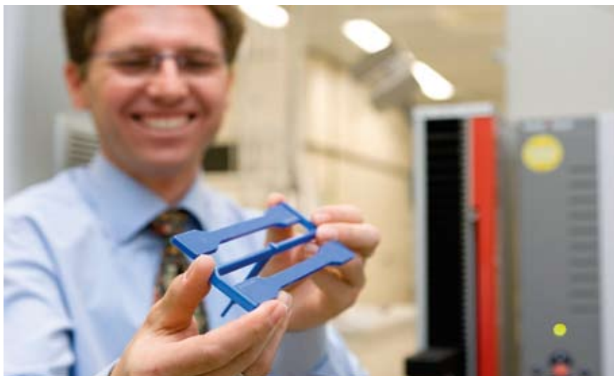
Bild 1: Die Quelle vieler Eigenschaftskennwerte in der Thermoplast-Welt: Der Spritzling Typ A nach DIN EN ISO 294-1 für den Vielzweckprobekörper Typ A nach DIN EN ISO 3167
