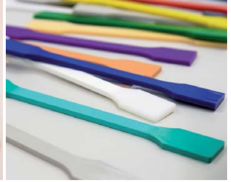
Auf Biegen und Brechen: Für die Laborprüfungen werden normierte Probekörper verwendet, sogenannte „Knochen“.
